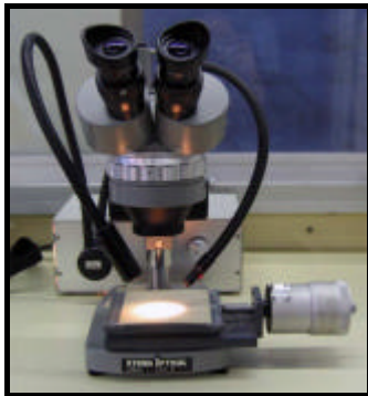
Figura 13. Microscopio con el micrómetro montado y la luz de fuente fría para iluminar la muestra.
